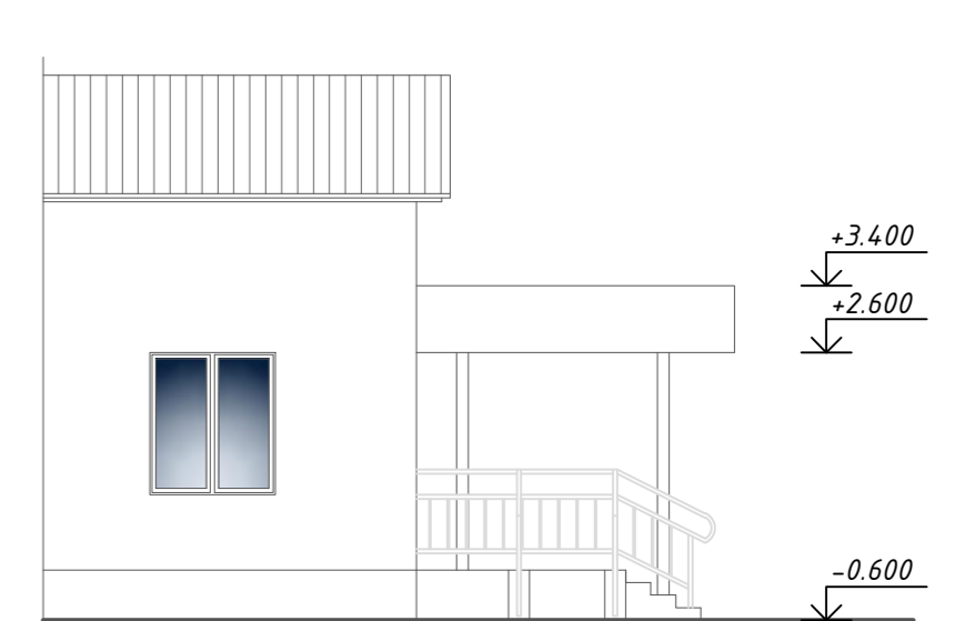
Фрагмент бокового фасада 2. Входной тамбур
