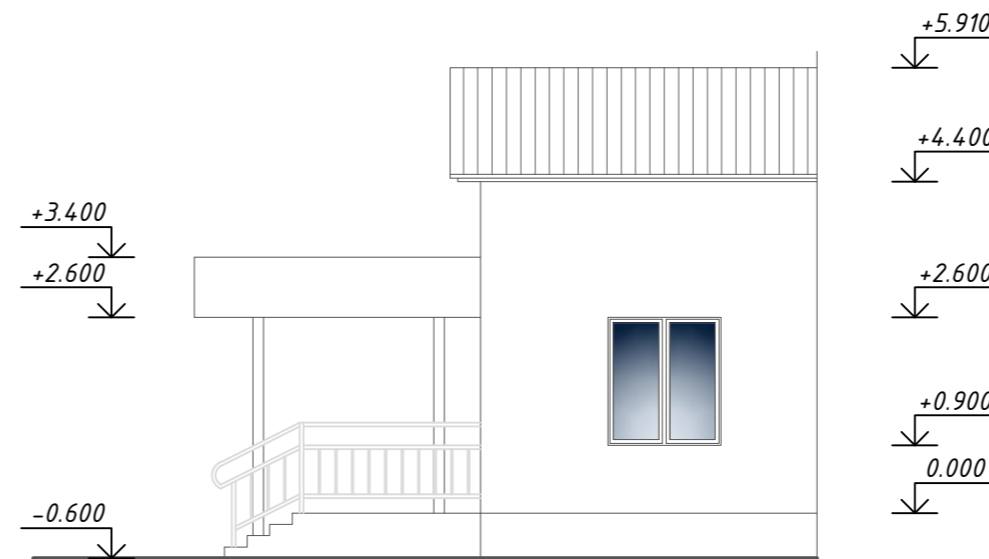
Фрагмент бокового фасада 1. Входной тамбур
